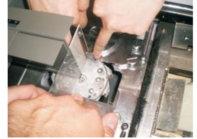
Freze ve çentik bıçağı 1 mm derinlikte kitap sırtını keser.
